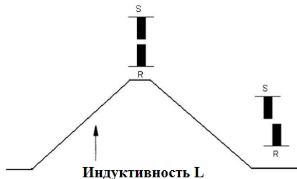
Рисунок 4. Зависимость индуктивности от положения ротора.
