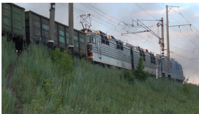
Рисунок 1 – Прохождение нейтральной вставки под током
