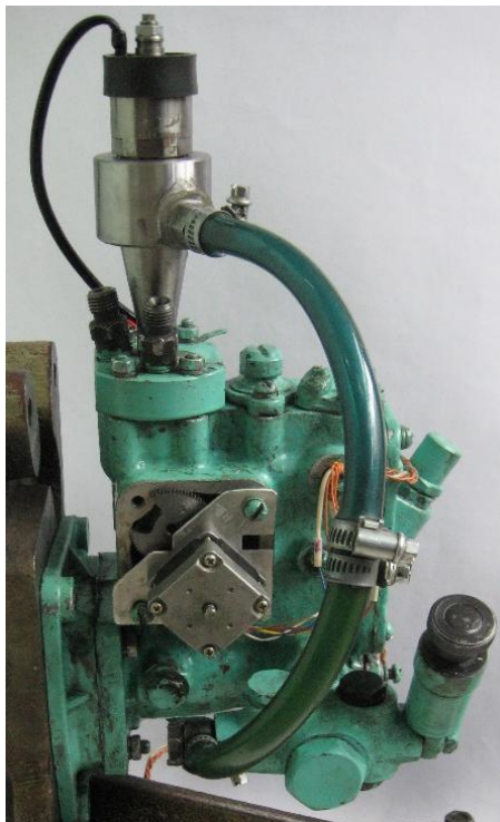
Рисунок 2 Экспериментальный насос НД-21/2 с вмонтированным клапаном Denso
