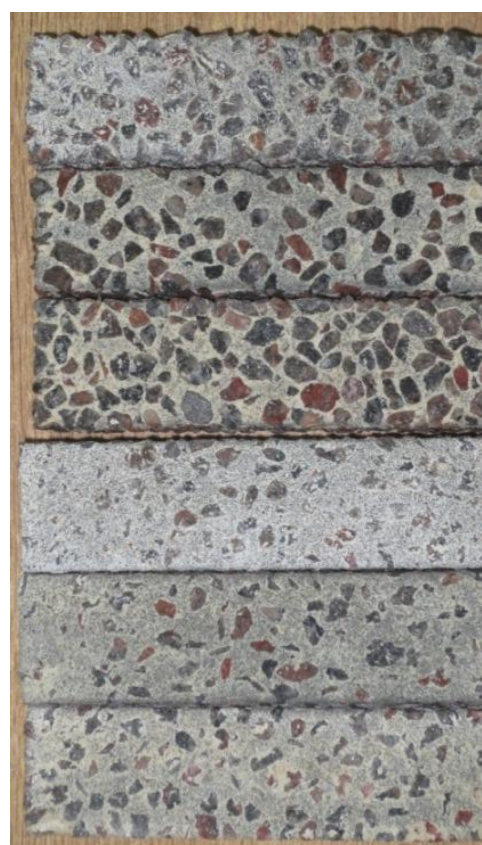
Рис. 2. Образцы цементного бетона с В/Ц 0,5 (а, г), 0,4 (б, д) и 0,3 (в, е) после экспонирования в растворах кислоты с концентрацией 2,5 % (а, б, в) и 5 % (г, д, е)
