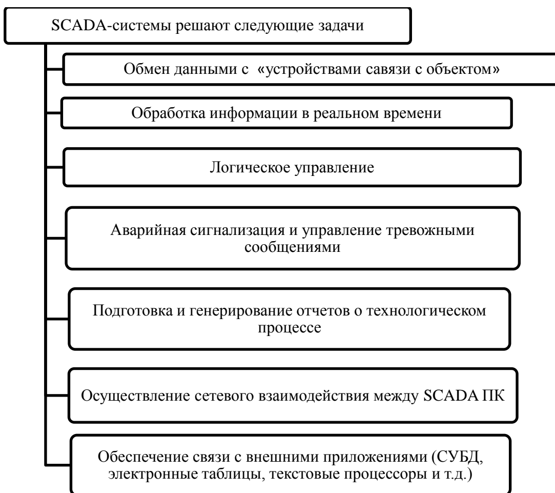
Рисунок 1 «Задачи, решаемые SCADA-системами»
