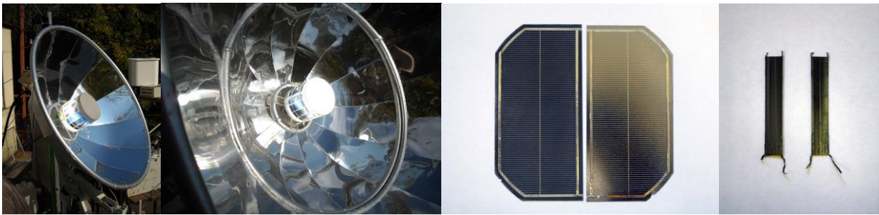
Рис. 1. Солнечный теплофотоэлектрический модуль с концентраторами параболического типа (слева), планарные и матричные фотоэлектрические преобразователи (справа)
