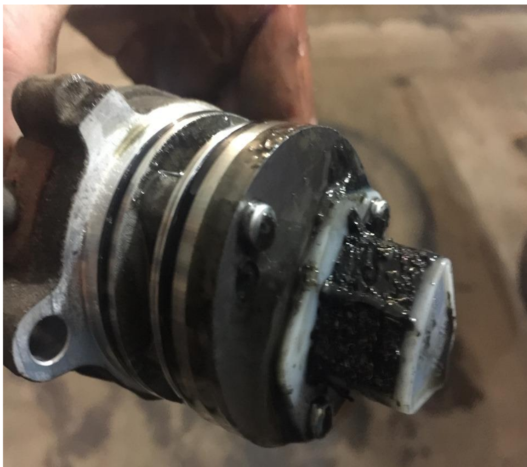
Рис. 4 Фото масляного насоса на автомобиле Volvo XC70 с пробегом 46.000 км.
