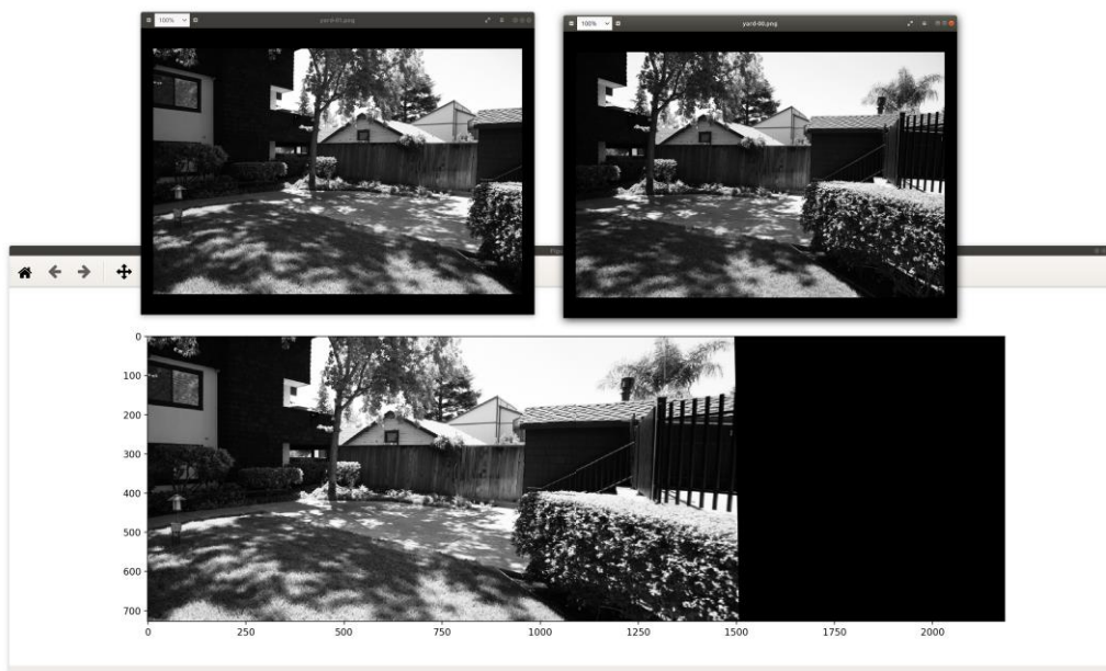
Рис. 5. Склеивание панорамы с помощью метода SIFT
