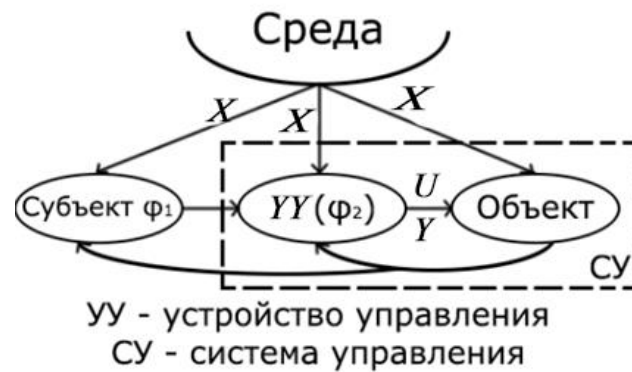
Рисунок 3. Взаимодействие элементов системы управления
