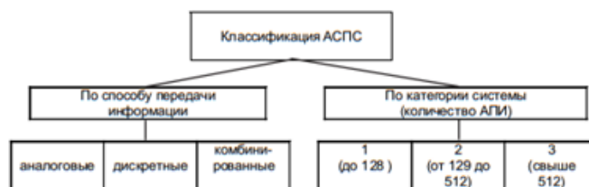
Классификация адресных систем пожарной сигнализации
