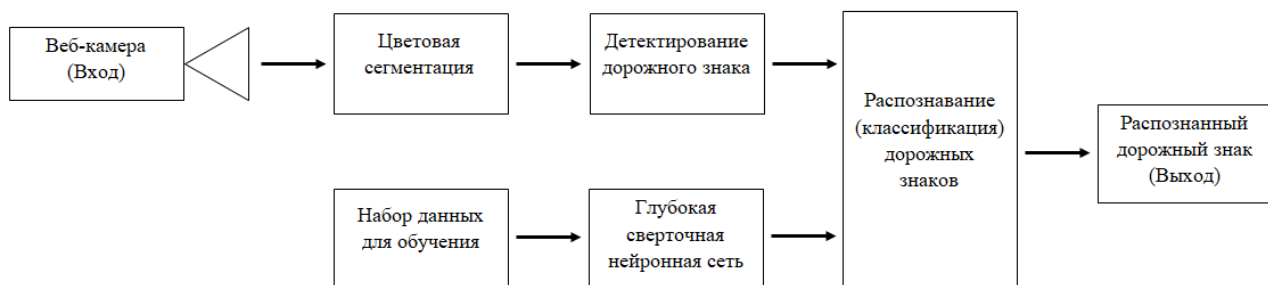
Рис.1. Общий вид модели системы распознавания дорожных знаков
