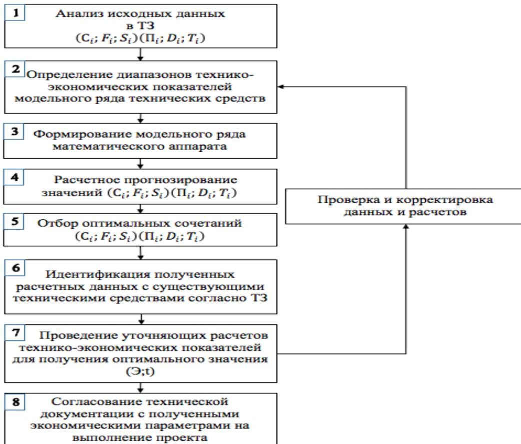
Рисунок 2 – Алгоритм прогнозирования и расчета экономической эффективности и сроков окупаемости автоматизированных технических средств для ЖКХ
