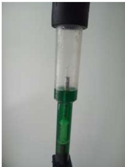
**Рисунок 2** – Измерение температуры начала кристаллизации (замерзание)
