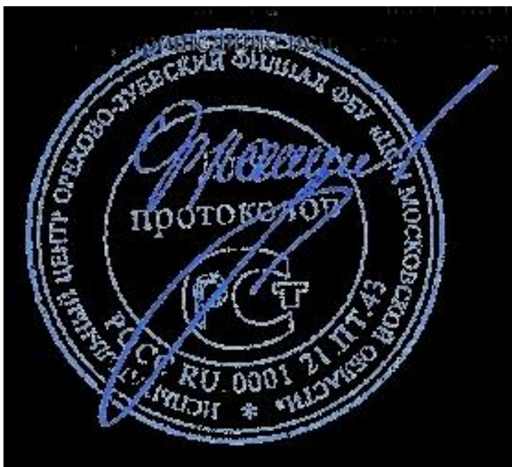
Рис. 2. Распознанное с помощью цветового фильтра изображение печати на исходном обрабатываемом документе
