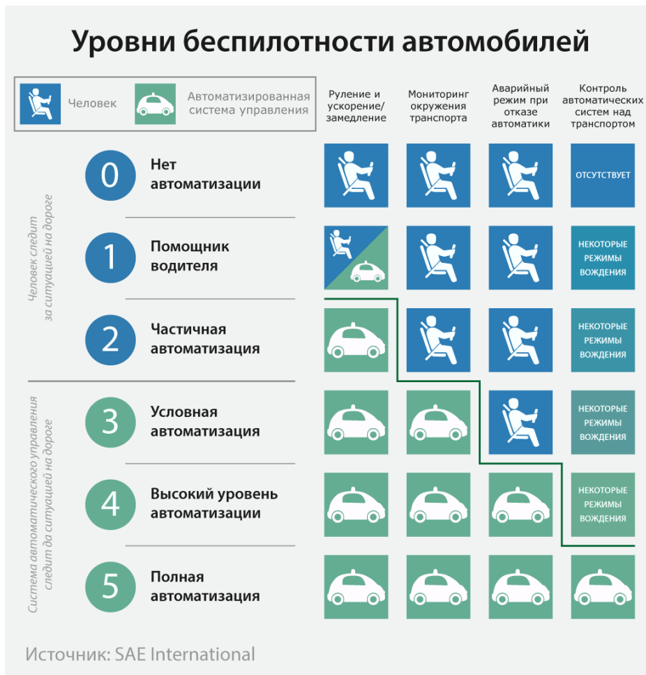
Рис. 1 – Уровни автономности автомобиля
