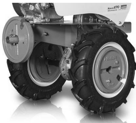
Рисунок 4 – Варианты навешивания грузов-утяжелителей на мотоблок
