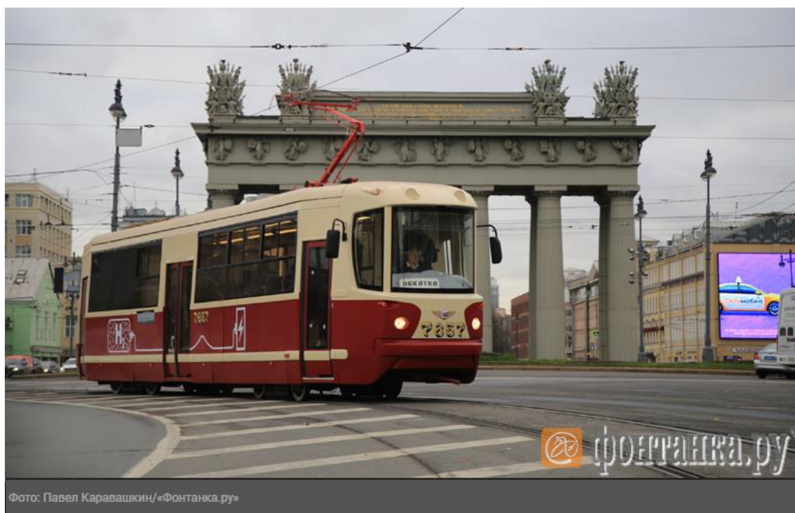
Рисунок 1– Фотография опытного трамвая на топливных элементах
