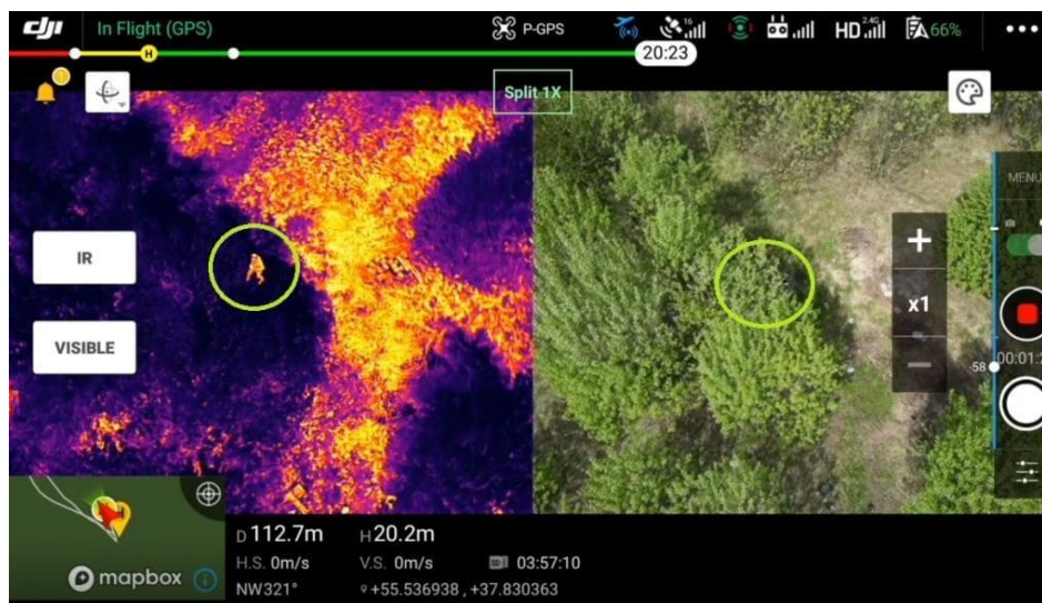
Рисунок 2. Съемка пожара с дрона, оснащенного тепловизором
