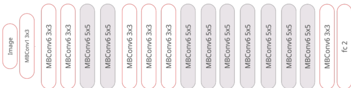
Рис. 4. Архитектура нейронной сети EfficientNet
