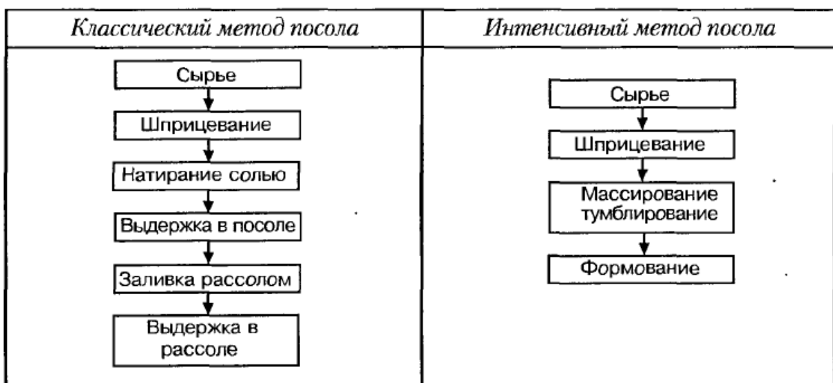
Рисунок 3 – Технологическая схема посола сырья классическим и интенсивным методами
