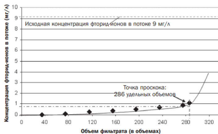
Рисунок 4 – Зависимость объема подаваемого раствора от содержания фторид-ионов в воде
