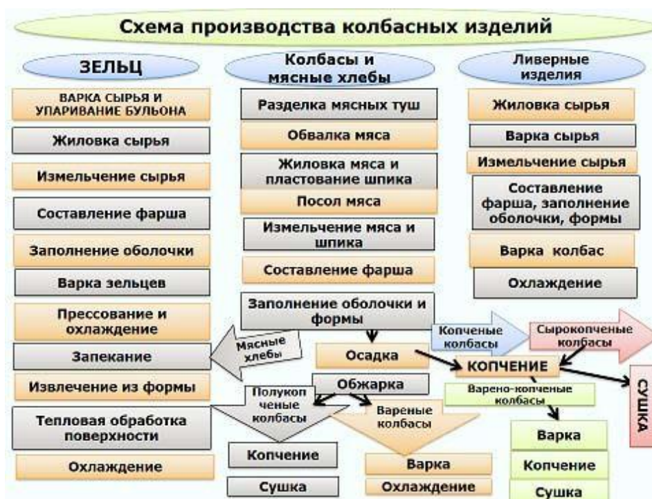
Рисунок 1 – Типичная технологическая схема производства колбасных изделий
