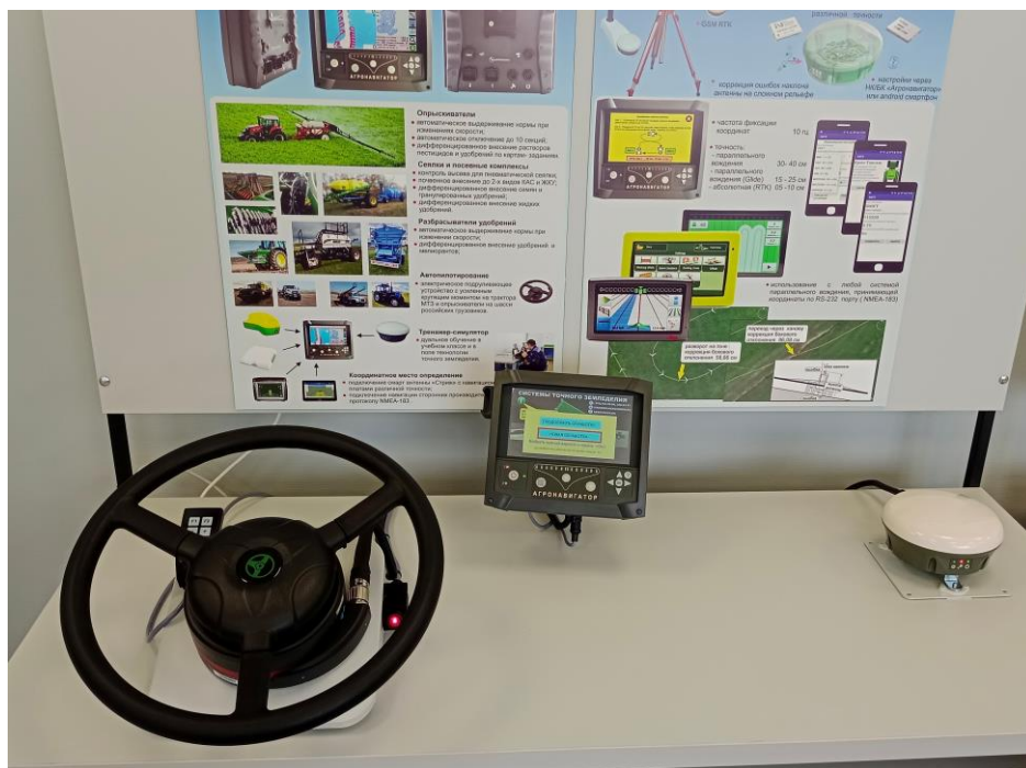
Рисунок 3 – Система параллельного вождения Агронавигатор 7 тип от компании ООО «ЦТЗ Аэросоюз»
