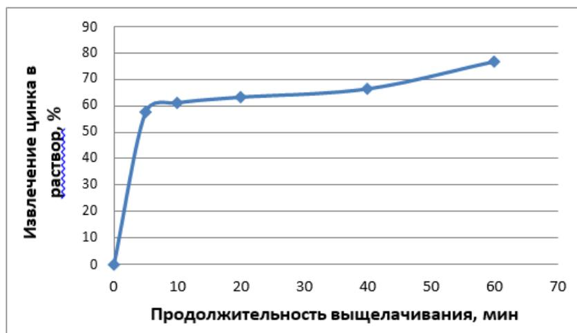
Рис 1. Зависимость степени извлечения цинка в раствор и продолжительности процесса выщелачивания от мелкой фракции руды (класс-1+0 мм) (t=600C)
