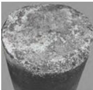
Рис1. Внешний вид контрольного образца после теста на ускоренное засоление
