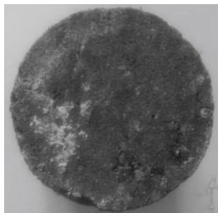
Рис 3. Внешний вид образцов композиций с микрокремнеземом МК-85 и без пластификаторов
