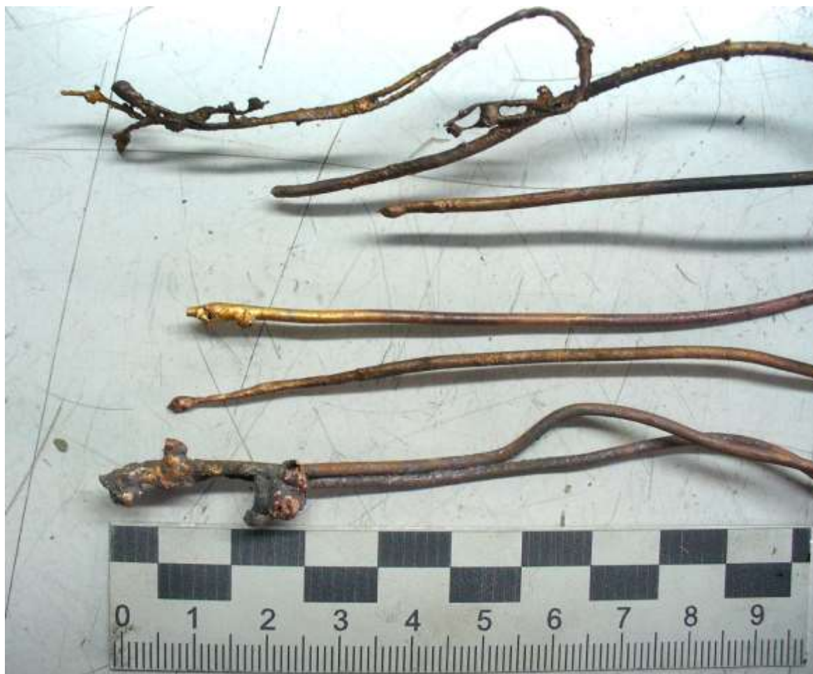
Рисунок 2 – Оплавление в виде шарообразных образований от короткого замыкания при пожаре
