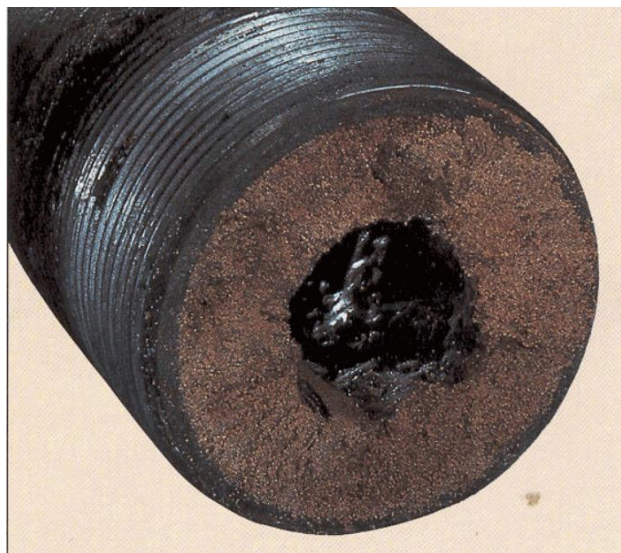
Рисунок №1- Парафиновое отложение в скважине
