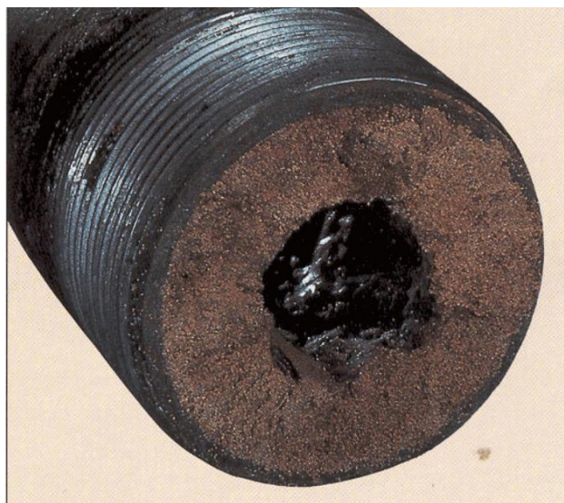
Рисунок №1- Парафиновое отложение в скважине
